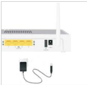
Слика 5. Вклучување на уредот на електрично напојување
