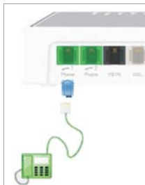
Слика 3. Приклучување на телефонски апарат
