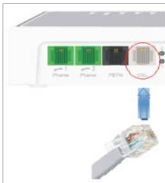
Слика 2. Приклучување на DSL
